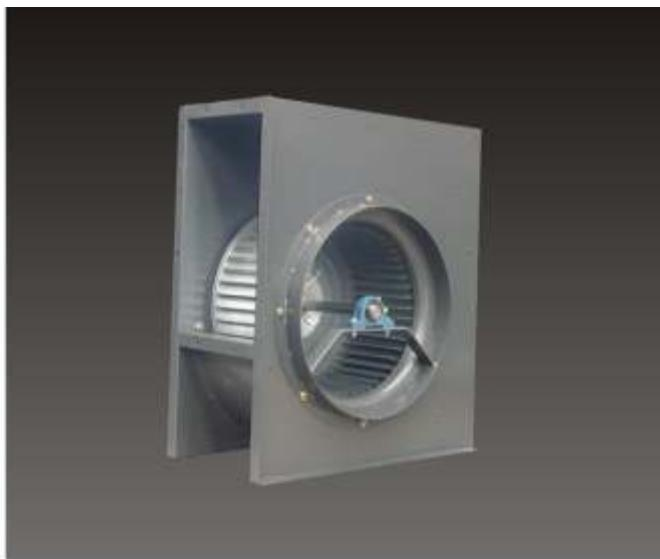
Los ventiladores SA son ventiladores centrífugos de simple oído, equipados con una turbina con álabes o palas curvas adelantadas. El diseño de este tipo de turbinas es especial para manejar grandes caudales de aire a medianas presiones estáticas; manteniendo un bajo consumo de energía. Estas prestaciones altas, se deben llevar a cabo en condiciones de aire limpio, sin polvo o grasa, con temperaturas no mayores a 80 °C.
